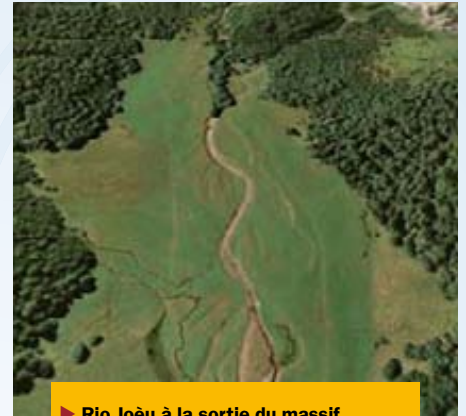
► Rio Joèu à la sortie du massif d'Aneto ; commentaire : La pente, les crues fortes en période de fonte, les matériaux abondants issus de l'érosion glaciaire et l'absence de végétation arborée favorisent un tracé avec des chenaux divagants larges et peu profonds. Lorsque le débit est faible, seul le chenal principal reste en eau, tandis que les chenaux secondaires et les bancs de graviers se couvrent de végétation herbacée.
